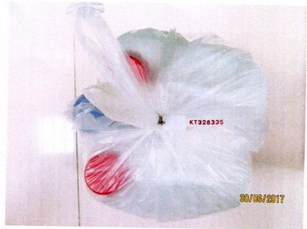
Mẫu nước được niêm phong
